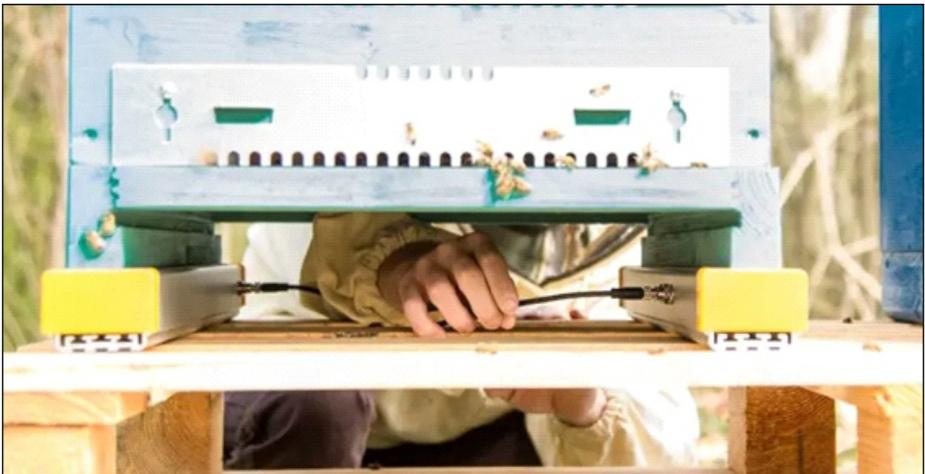
*Dispositivo externo para medir el peso, la temperatura y la humedad de una colmena*
